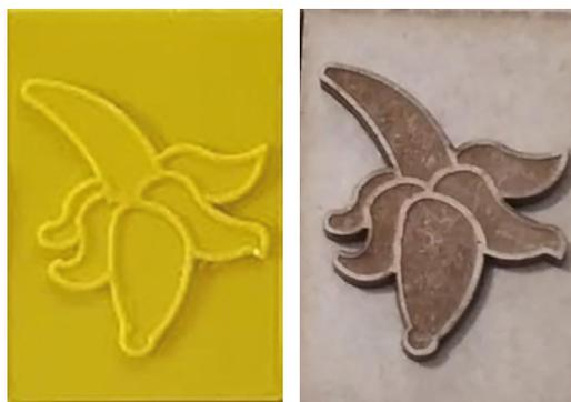
**Figura 1** – Peças de jogo da memória em PLA e em MDF, bananas semi-descascadas
