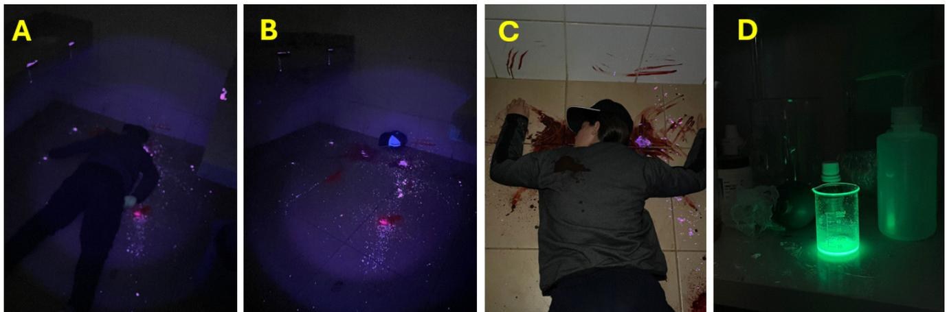
**Figura 1.** Simulação de uma cena de crime com o corpo com luz ultravioleta (A) e com luz visível (C). Cena do crime simulada com a luz ultravioleta (B) e o reagente luminol com 0,5 g de bicarbonato de sódio ( $\text{NaHCO}_3$ ) na ausência de luz (D).
